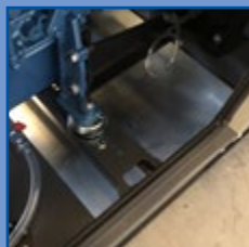
Защита от протечек экологическое решение для удержания жидкостей в случае протечки
