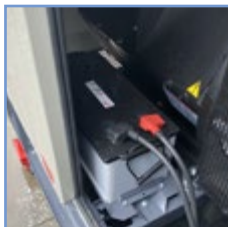
Свинцово-кислотный стартерный аккумулятор поставляется уже заряженным и готовым к работе
